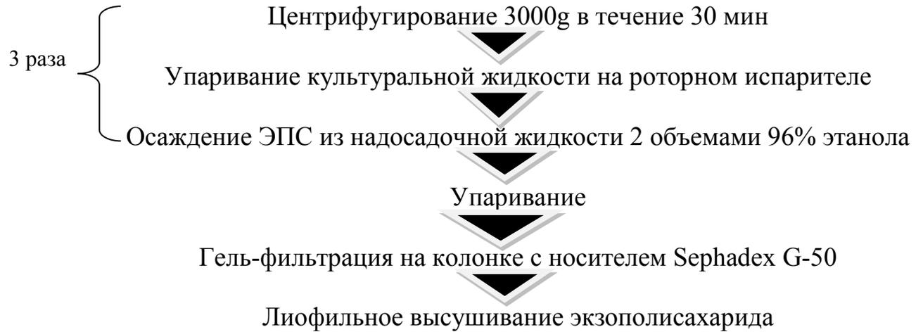
Рисунок 4 – Схема выделения и очистки экзополисахаридов из культуральной жидкости *S. thermophilus*
